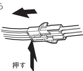
(3) 取付金具(両側)の引掛け部を取り付けバネから外す。
